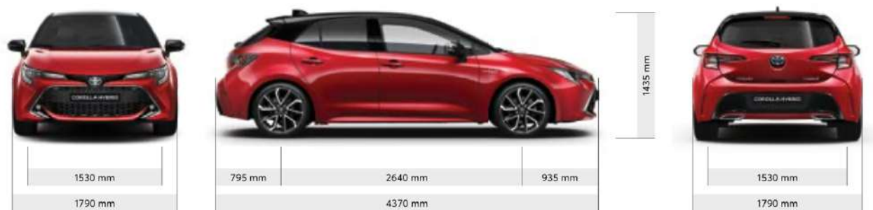
Εικόνα 36 Διαστάσεις του Toyota Corolla Hybrid
