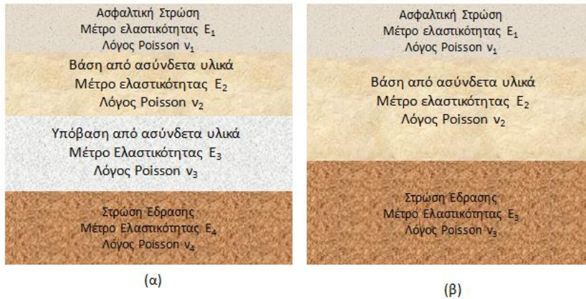
Εικόνα 2.2: Διατομές: (α) τεσσάρων στρώσεων, (β) τριών στρώσεων.
