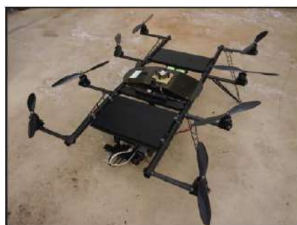
Εικόνα 2.5 Το drone HORUS που χρησιμοποιήθηκε για την καταγραφή των προσπεράσεων (Vettters & Jaehrig, 2015, October).
