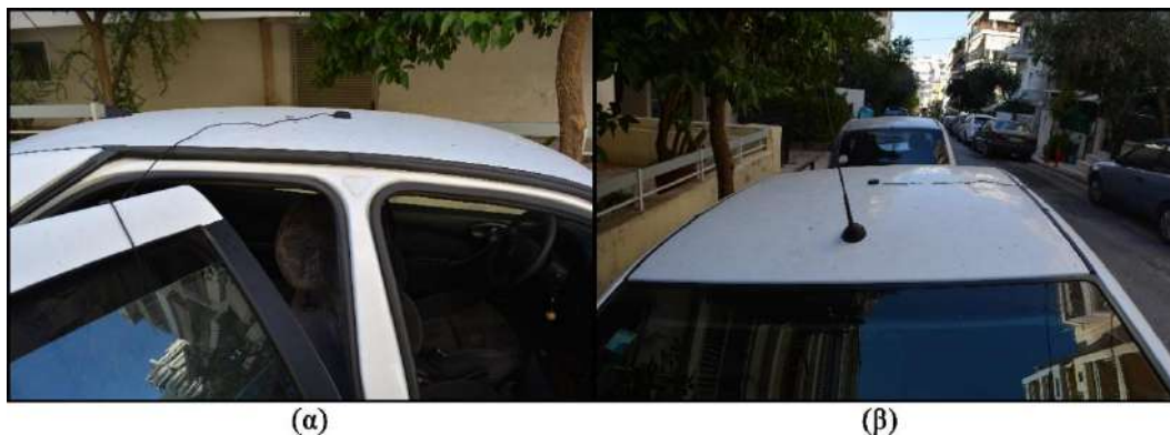
Εικόνα 4.16 Προσδιορισμός του σημείου τοποθέτησης του δέκτη GNSS στη διαμήκη (αριστερά) και την εγκάρσια (δεξιά).
