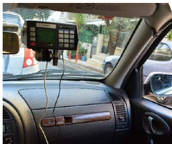
Εικόνα 4.20 Τοποθέτηση του VC4000RG στο εσωτερικό του ανεμοθώρακα.
