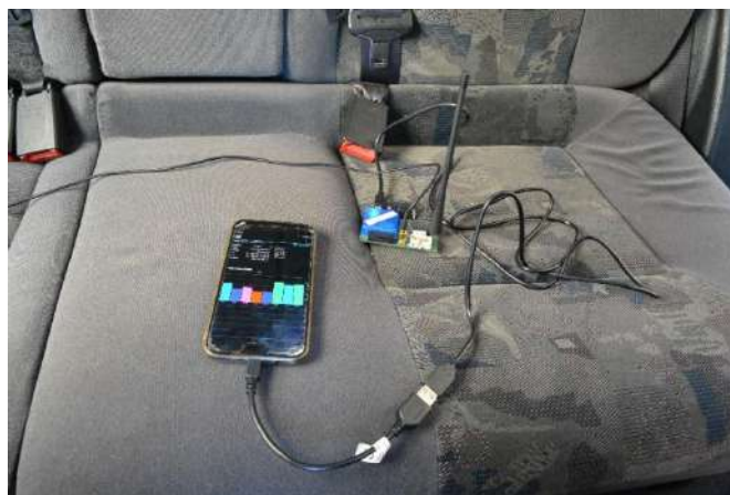
Εικόνα 4.17 Εναπόθεση του smartphone και του u-blox στα πίσω καθίσματα του οχήματος του πειράματος.
