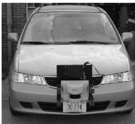
Εικόνα 2.3 Το όχημα καταγραφής με τα όργανα που χρησιμοποιήθηκαν στο πείραμα (Xuan & Coifman, 2006, September).
