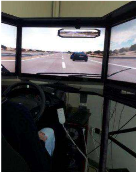
Εικόνα 2.6 Ο προσομοιωτής του Εργαστηρίου Κυκλοφοριακής Τεχνικής της Σχολής Πολιτικών Μηχανικών ΕΜΠ (Αλβέρτης, 2020).
