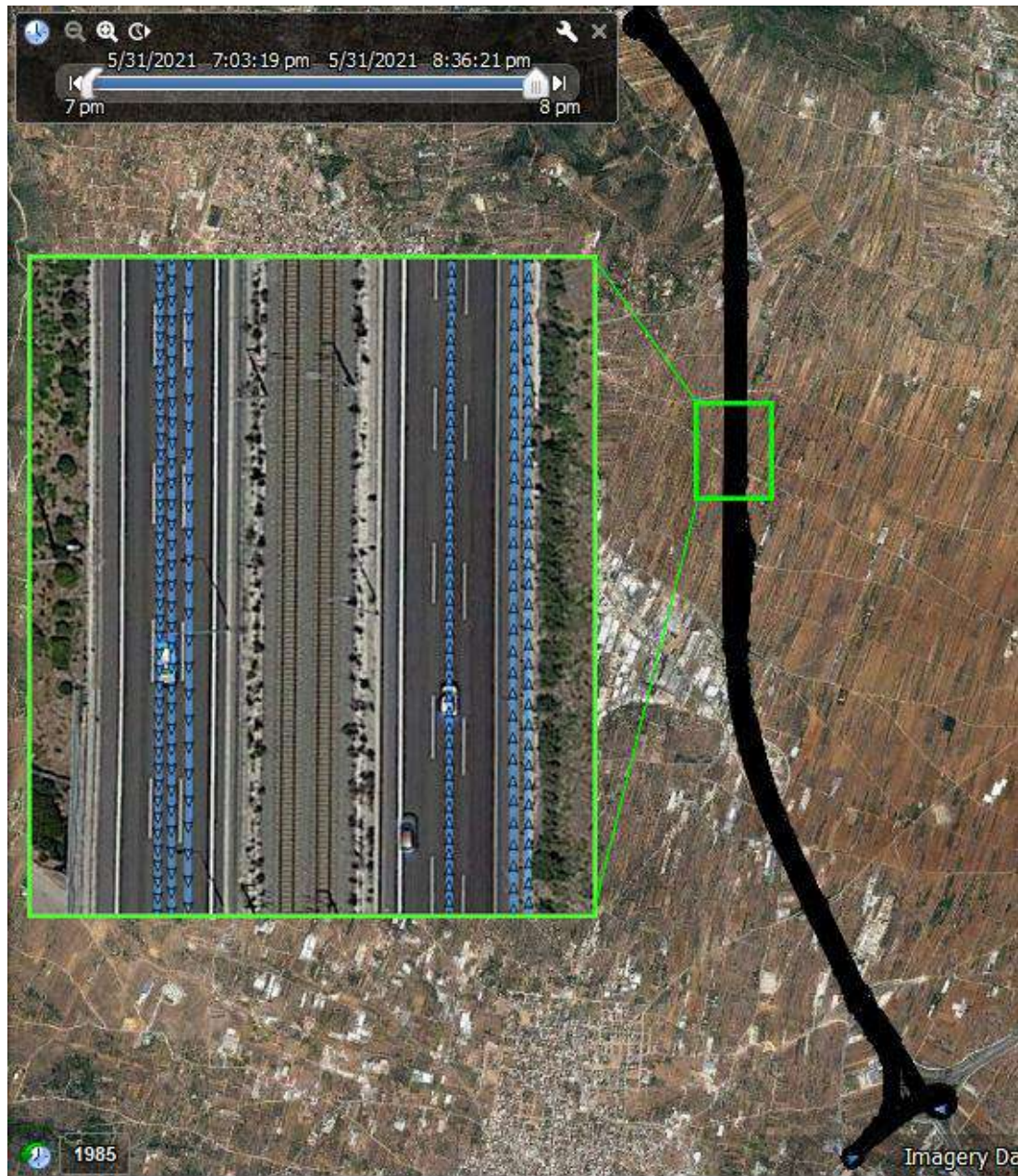
Εικόνα 4.33 Η απεικόνιση της τροχιάς ενός οχήματος στο Google Earth Pro μετά την εφαρμογή της τεχνικής RTK.
