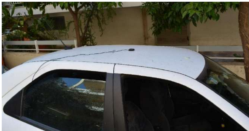
Εικόνα 4.15 Τοποθέτηση του δέκτη GNSS στην οροφή των οχημάτων του πειράματος.
