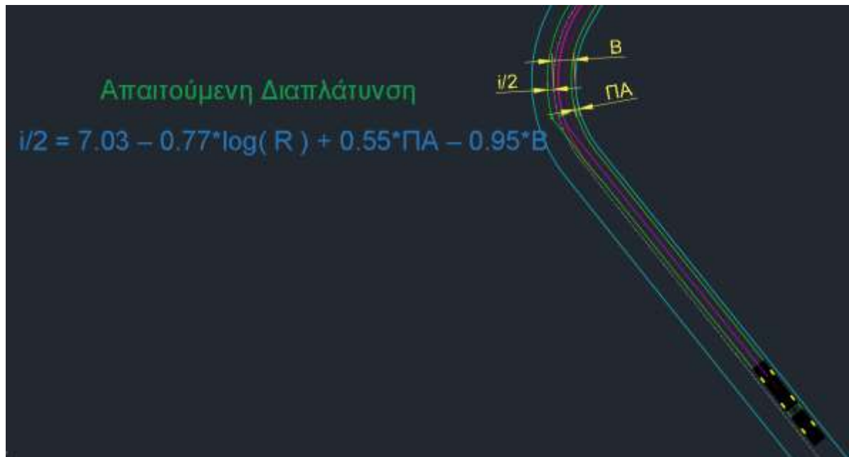
Εικόνα 4.15: Εξίσωση εύρεσης διαπλάτυνσης αρθρωτού λεωφορείου 242
