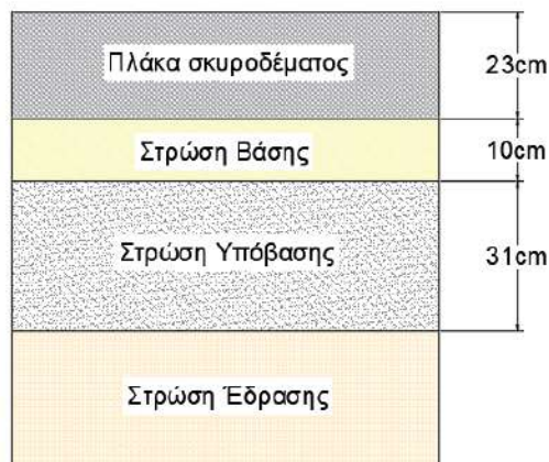
Εικόνα 5.8 Διατομή σχεδιασμού οδοστρώματος με τη μέθοδο MnPCC-ME
