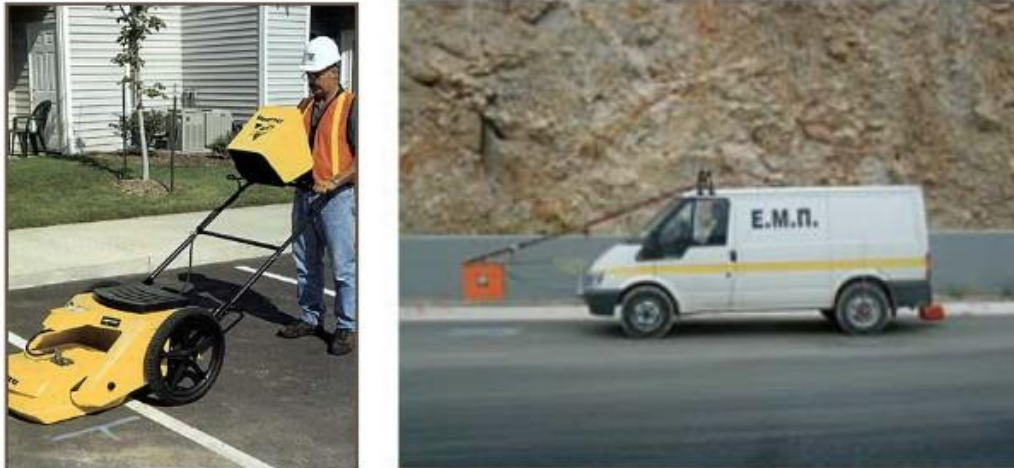
Εικόνα 3.4: Γεωφυσικό σύστημα GPR
