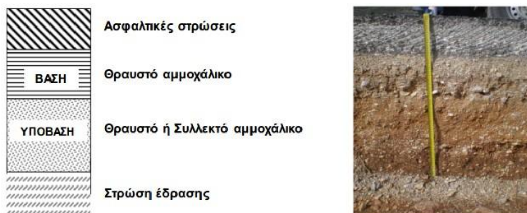
Εικόνα 2.3: Διατομή εύκαμπτου οδοστρώματος
