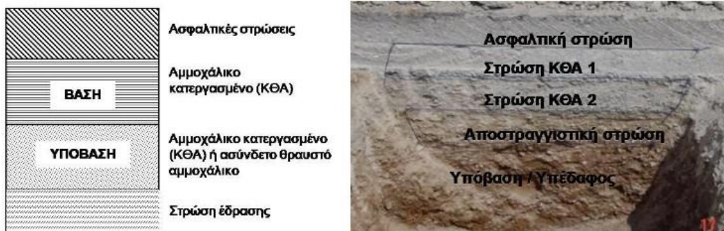
Εικόνα 2.2: Διατομή ημι-άκαμπτου/ημι-εύκαμπτου οδοστρώματος
