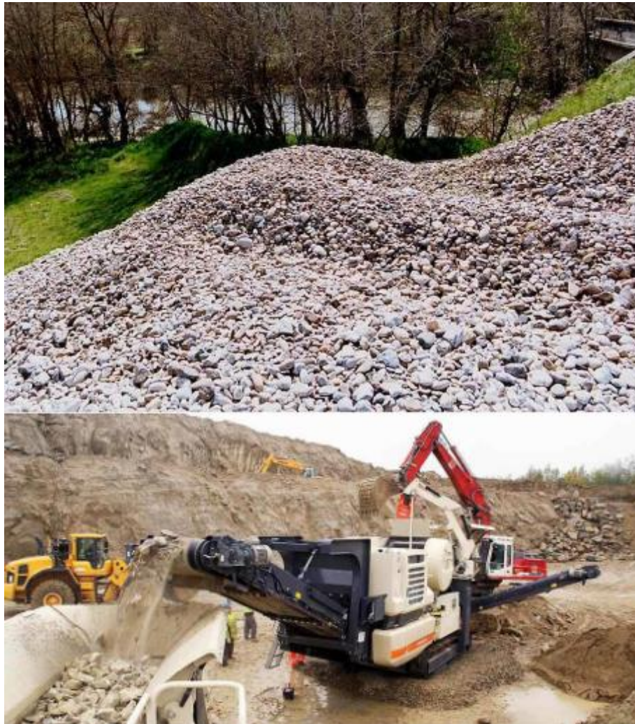
Εικόνα 2.5: Αδρανή υλικά: συλλεκτά (άνω) και θραυστά (κάτω)
