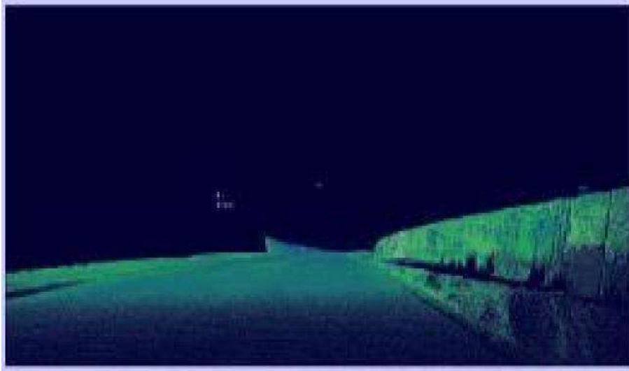
Εικόνα 2-3: Τρισδιάστατη απεικόνιση διατομής από τρισδιάστατη σάρωση οδού (Μαυρομάτης, Παγούνης, Παλάσκας & Μαρούδας, 2012)
