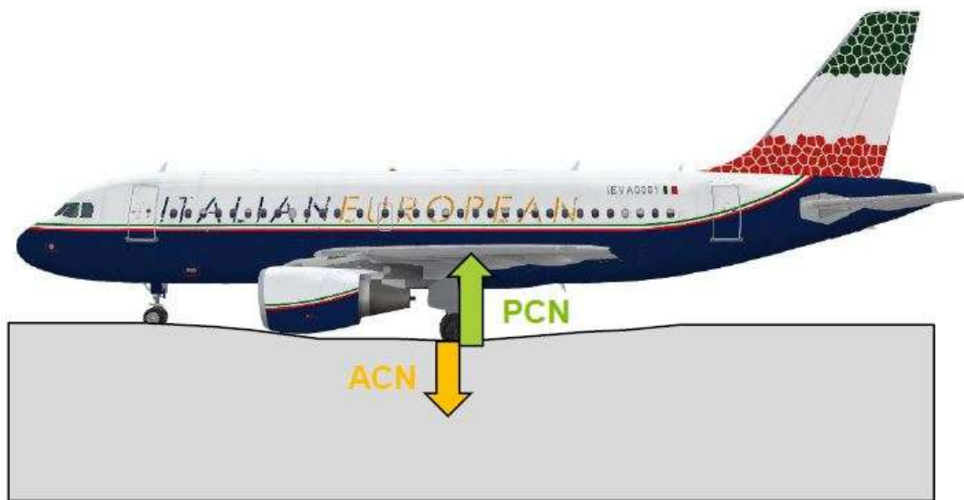
Εικόνα 2.1: Βασική Αρχή της Μεθόδου Δομικής Κατάταξης Οδοστρωμάτων Αεροδρομίων ACN-PCN (Fabre C., 2017)
