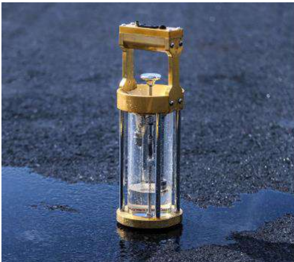
Εικόνα 2-12 Outflow Meter Test
