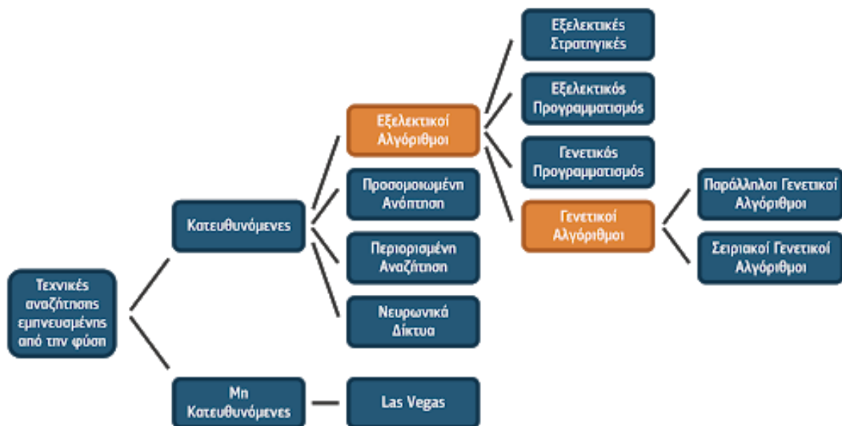
Εικόνα 1: Διακριτοποίηση μεταξύ των κατευθυνόμενων και των μη κατευθυνόμενων γενετικών αλγορίθμων
