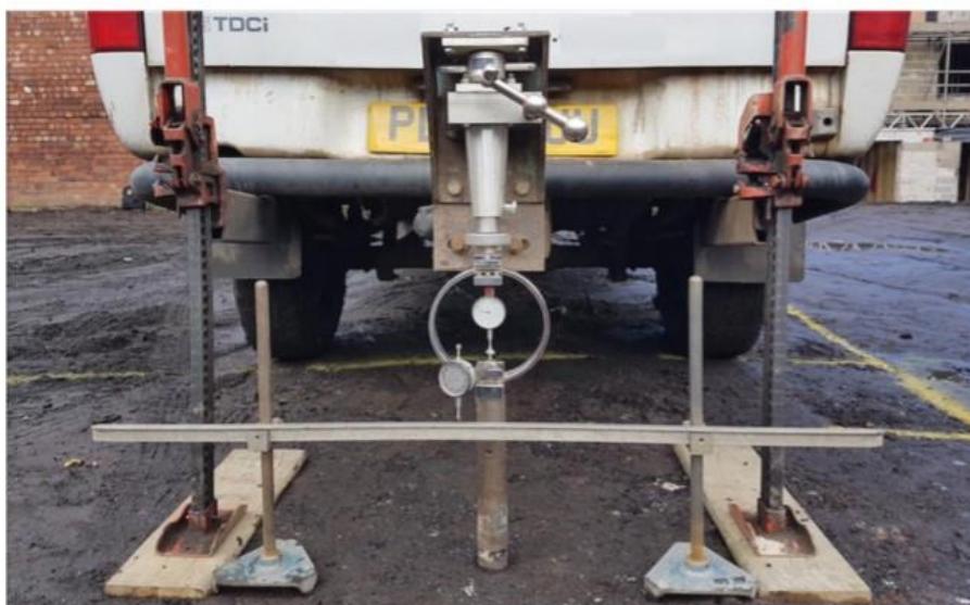
Εικόνα 2-6 Επί τόπου δοκιμή CBR ( www.subsurface.co.uk )
