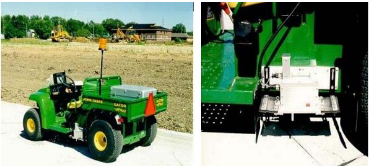
Εικόνα 2.6 Προφιλόμετρα υψηλής ταχύτητας με ανέπαφο αισθητήρα (MTAG, 2007)
