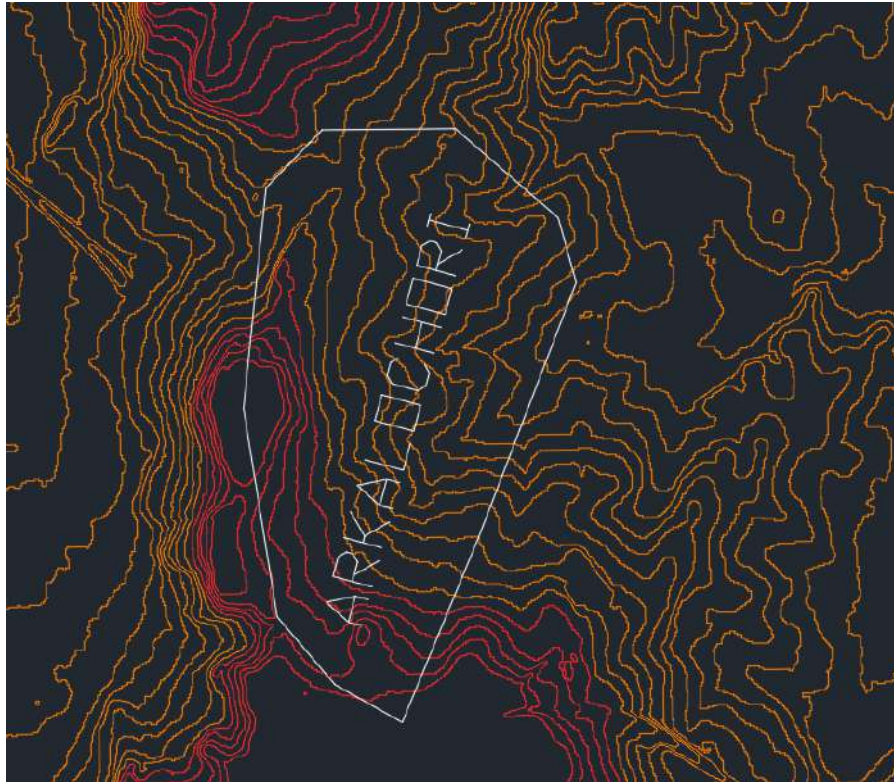
Εικόνα Π8.3 – Τα όρια του οικισμού μεταφέρονται μέσω polyline στο τοπογραφικό σχέδιο .dwg
