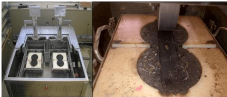
Εικόνα 3.26: Δοκιμή HWTT (Newcomb & Zhou, 2018)
