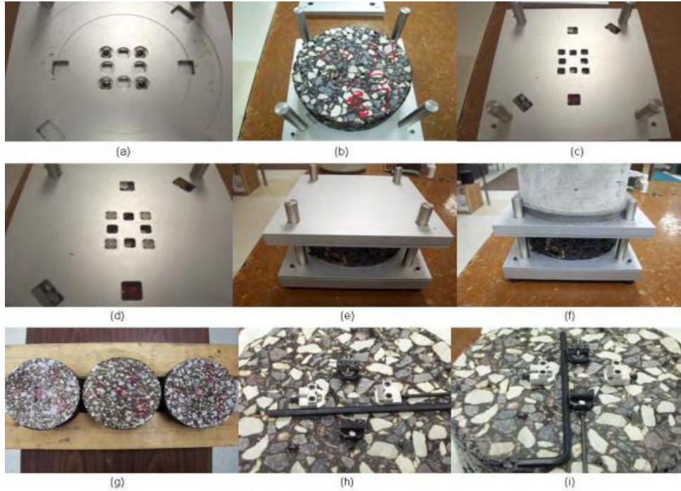
Εικόνα 3.34: Στάδια δοκιμής IDT (Richardson & Lusher, 2008)
