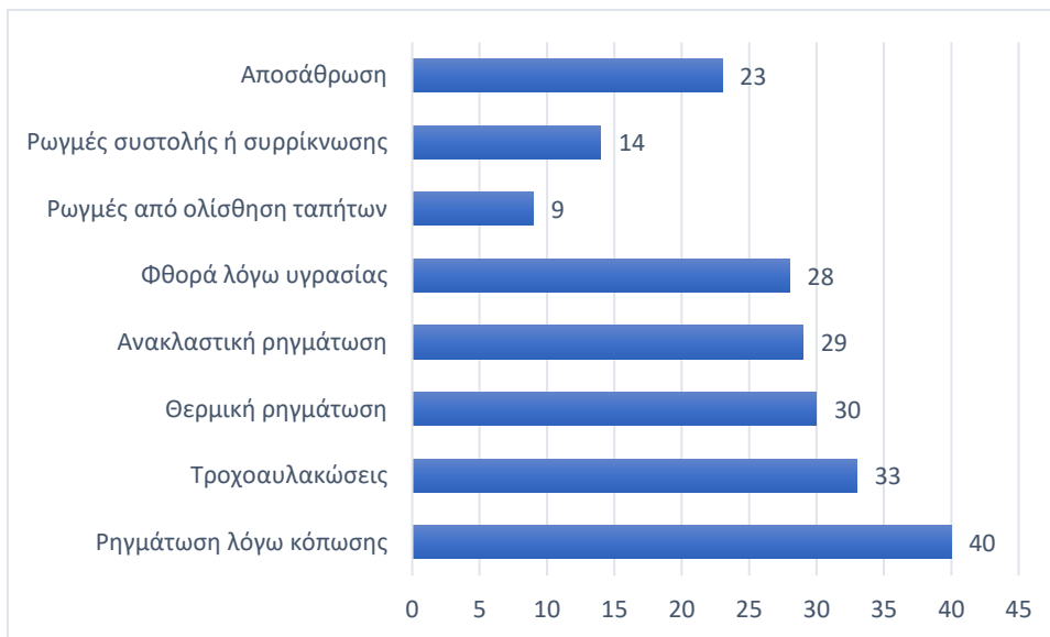
Εικόνα 4.7: Τύποι αστοχίας οδοστρωμάτων-Τμήματα Μεταφορών (West, et al., 2018)
