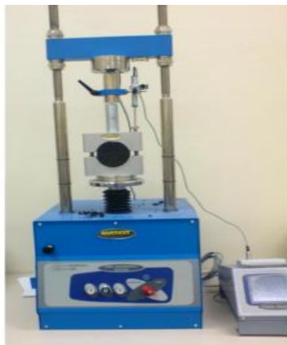
Εικόνα 2.19: Διαδικασία ελέγχου δοκιμών Marshall σε ευστάθεια-παραμόρφωση (Λοΐζος & Πλατή, 2019)
