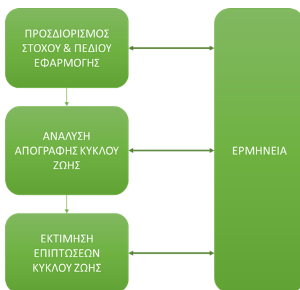
Εικόνα 3.2 Δομή ανάλυσης κύκλου ζωής (Harvey et al., 2016).
