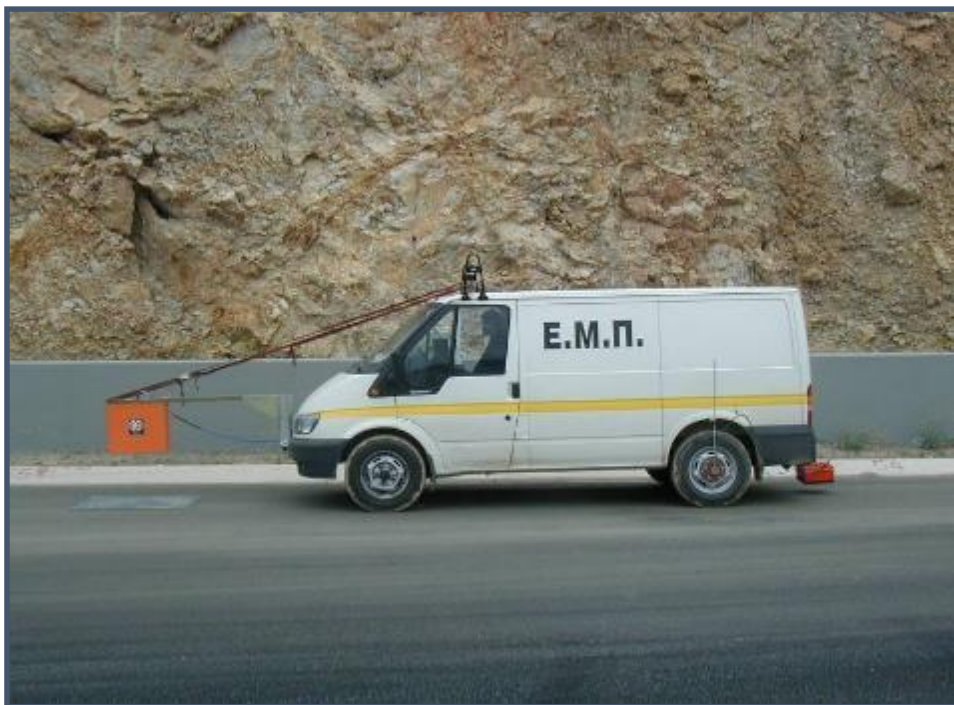
Σύστημα καταγραφής στρωματογραφίας των οδοστρωμάτων GPR (Ground Penetrating Radar)
